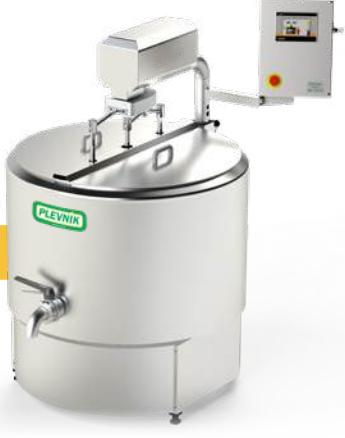
Professioneller, autonomer und effizienter Käsekessel für erfahrene Benutzer. Ermöglicht ein schnelleres Erhitzen – verfügt über ein geschlossenes Drucksystem (höhere Temperaturen) und indirekte Kühlung. Schneidet die Käsemasse automatisch (automatische Harfen). Der Kessel steht auf einem stabilen Untergestell mit Kippmechanismus. Inox-Abdeckung zum Schutz des Motors.
