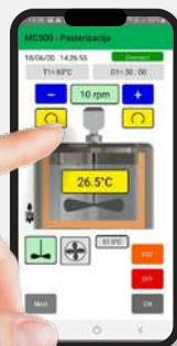
In der mobilen Anwendung für MC 500 und MC 500 R können Sie Folgendes einstellen: ein-/ausschalten, Startverzögerung, Übertragung der Aufzeichnungen, mit dem nächsten Prozessschritt fortfahren, Temperatur und bestimmte andere Parameter ändern, z.B. Geschwindigkeit und Rührrichtung.
