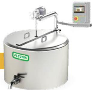
Käsekessel mit einer einfachen Dreimantelkonstruktion (Wasserbad), elektrischer Heizung (EL), Anschlüssen für die Kühlung mit Wasser aus dem Verteilungsnetz und einem Propellerrührer.
